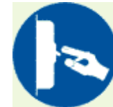
OBBLIGO DISINSERIRE INTERRUTTORE
