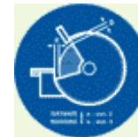
ASSICURARSI, PRIMA DI ESEGUIRE MOLATURE, CHE IL POGGIAPEZZI E LA LINGUETTA DISTINO DALLA MOLA COME INDICATO
